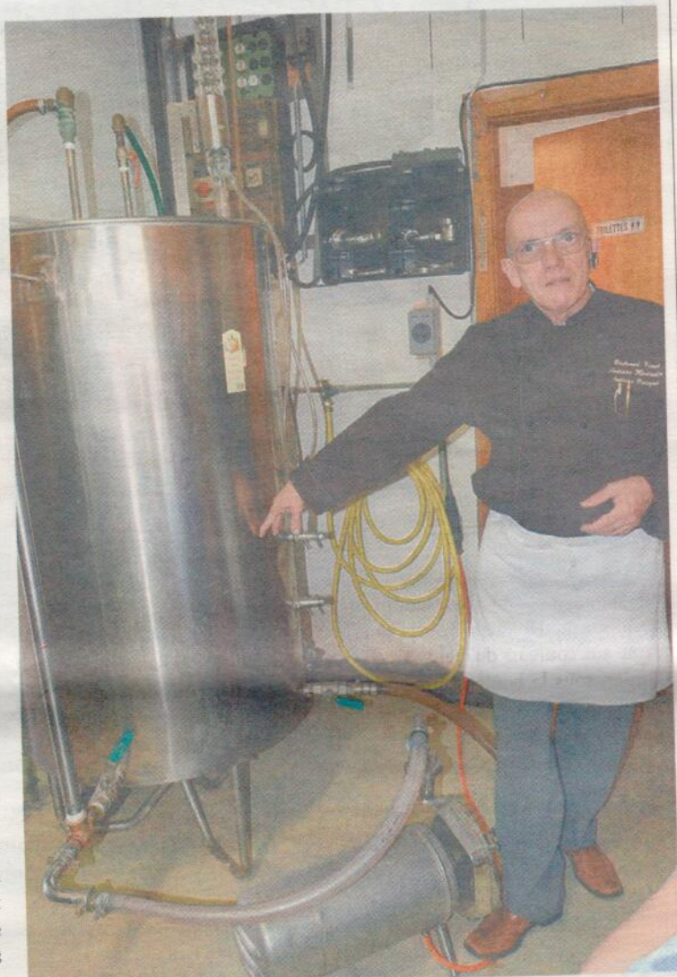
Bertrand Boesch devant l'acétateur qui permet l'élaboration du vinaigre.
